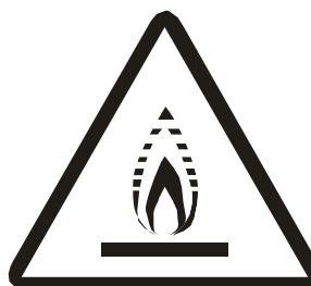
Avertissement : matériau à faible vitesse de combustion (Pour les produits contenant un réfrigérant R32, respecter uniquement la norme IEC 60335-2-40:2018)
